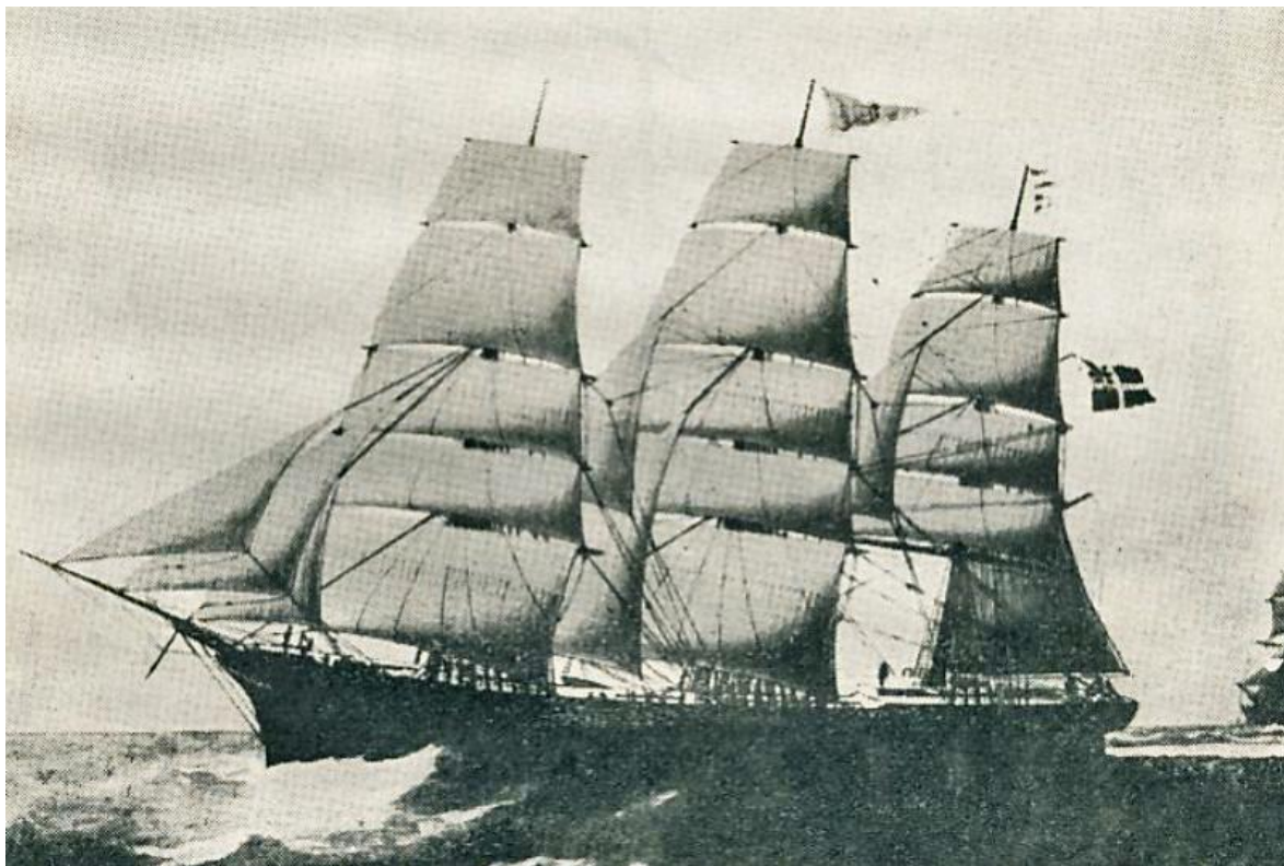
Fullriggeren Ellisif på ca. 1000 reg. tonn. Bygget i New York i 1856. 170 fot lang og 36 fot bred og trenger 21 fots dybde. Selv for landkrabber fra Ringerike må dette høres imponerende! Innkjøpt til Moss av bankkasserer Stephanus Rumi.
